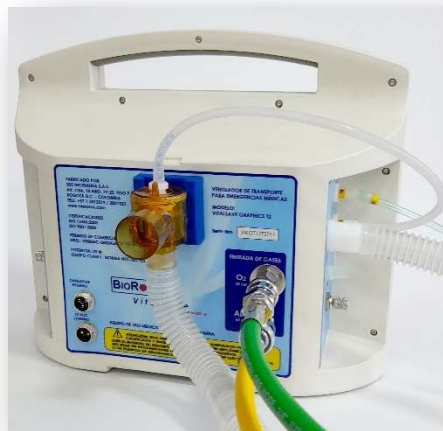
Figura 4-2: Ensamble del circuito respiratorio
