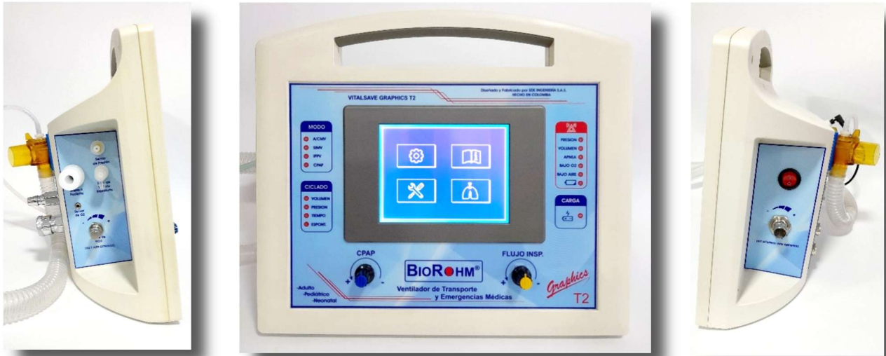
Figura 9-1: Perillas FiO2 21%, CPAP, Flujo Insp, y FiO2 60%
