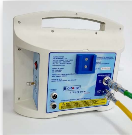
Figura 4-1: Conexión Alimentación de Gases
