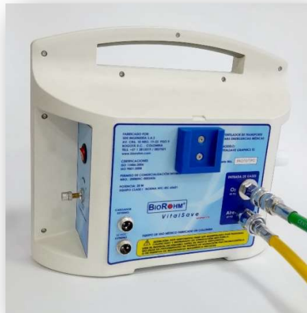
Figura 4-1: Conexión Alimentación de Gases
