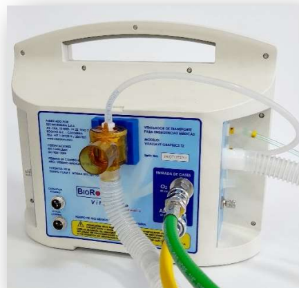
Figura 4-2: Ensamble del circuito respiratorio
